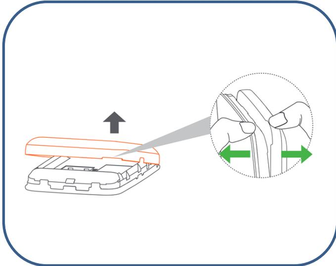
Abra la tapa trasera, para lo que se recomienda que coloque la punta de sus dedos pulgares en la ranura al mismo tiempo y deslice la tapa hacia afuera para abrirla.
